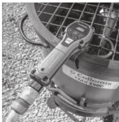
Einhängen an einer Mischertrommel
