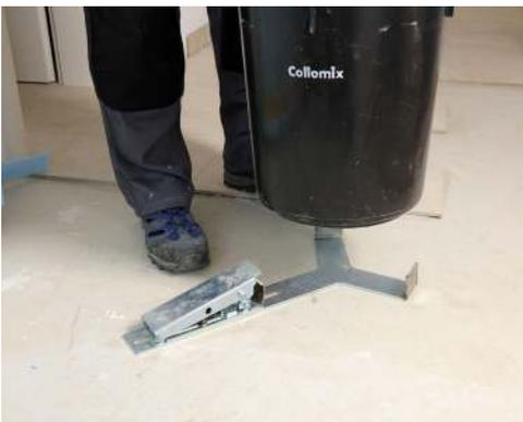
Gerade kleinere Mischeimer fangen während des Mischvorgangs an sich zu drehen. Häufig ist die Konsequenz, dass man sich den Eimer noch zwischen die Füße klemmt. Das ist nicht nur unbequem, sondern kann auch gefährlich werden wenn man dabei das Gleichgewicht verliert.
